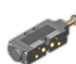
pilotni ventil 5/2-potni ventil co-ax, elektropnevmatsko, G1/4, p = 4 - 10bar
